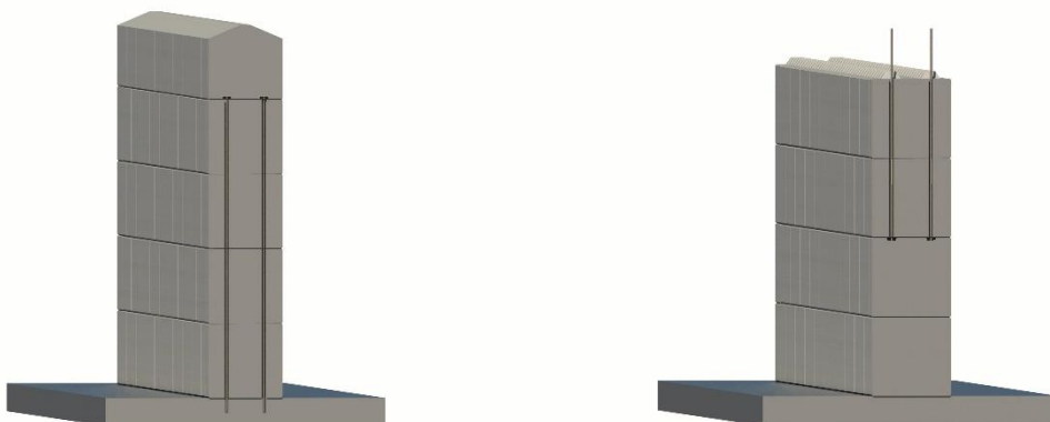
Figur 5.2i-j. Inspända C3Cblock, platta på mark med toppblock och toppskift.
