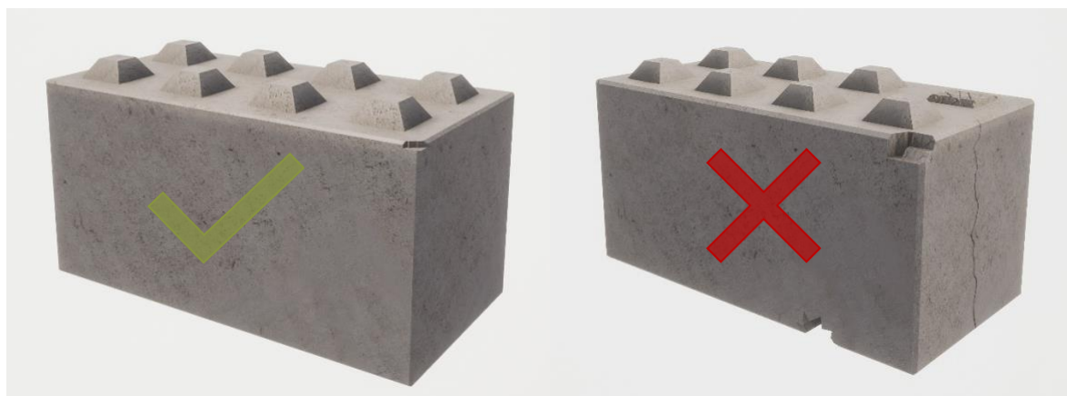
Figur 6.5e-f. Blockbedömning sett till sprickbildning samt kantstötningar.
